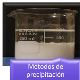
El analito se separa de los demás constituyentes de la muestra por formación de un compuesto insoluble. El peso del analito en la muestra se determina a partir del peso del compuesto obtenido inicialmente, o de un compuesto producido posteriormente por calentamiento.
